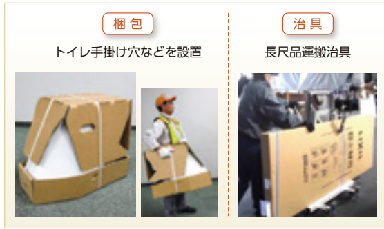
図1. ドライバーの作業負荷を改善する梱包や治具の例
